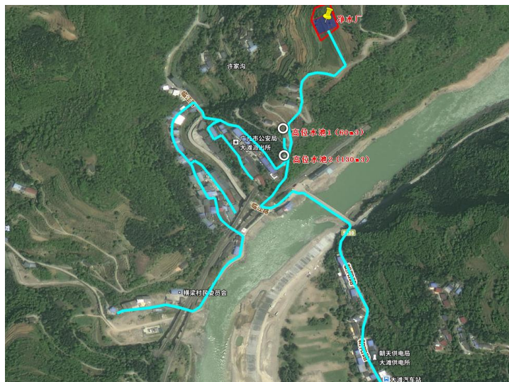
图 1-2 项目净水配水管线平面布置图
