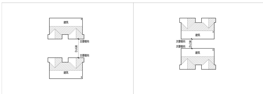
图 4-1 平行布置时建筑间距示意图
